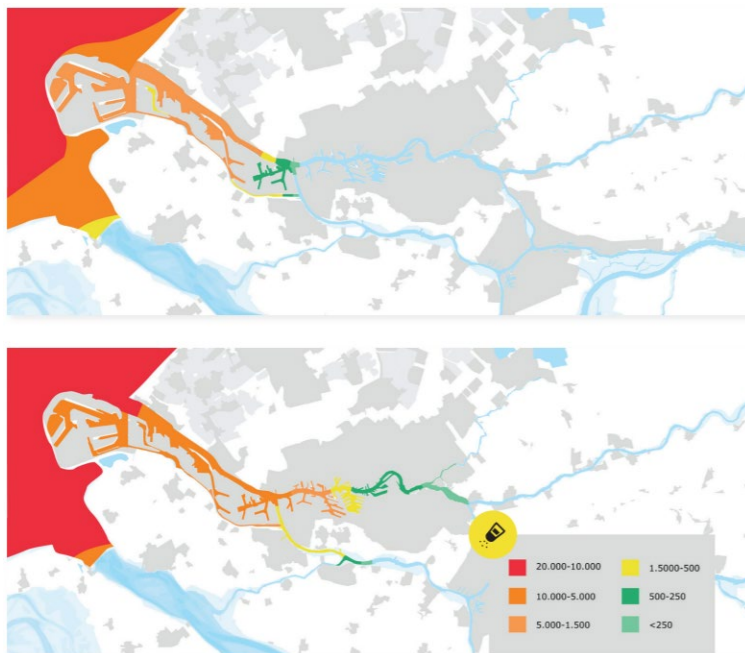
Figuur 3.42: Het zoutgehalte in het water van de Rijn-Maasmond bij gemiddeld getij en een relatief lage (boven: 1100-1200 m 3 /s) respectievelijk hoge (onder: 5000-6000 m 3 /s) afvoer van de Rijn bij Lobith [Platform Rivierkennis van Rijkswaterstaat, 2019]
